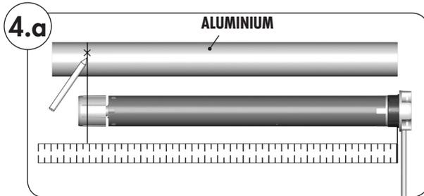
1. Messen Sie den Abstand zwischen Adapter (8) und dem hinteren Drittel des Mitnehmers (10) und zeichnen Sie diesen Abstand auf das Präzisionsrohr.
