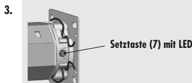
Zur Quittierung fährt der Rohrmotor kurz auf und ab und die LED in der Setztaste (7) leuchtet orange.
