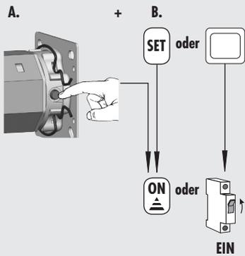
**Zuerst die Setztaste (7) am Rohrmotor (9) und anschließend die SET-Taste am Schnurschaltersetzgerät (20) (eventuell durch eine zweite Person) drücken und gedrückt halten.**
