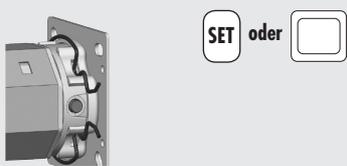
**Die Setztaste (7) am Rohrmotor (9) und die SET-Taste (oder den externen Taster, falls angeschlossen) wieder loslassen.**
