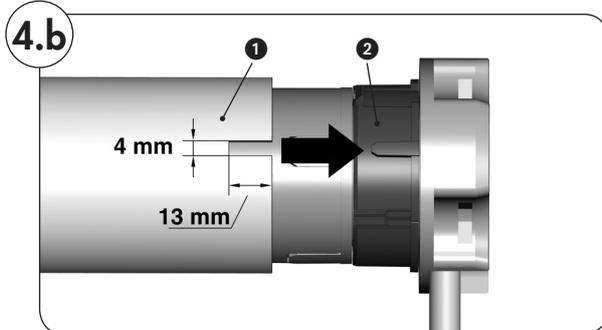
2. Sägen Sie am Ende des Präzisionsrohrs eine Nut ① aus, damit der Nocken ② des Adapters (8) ganz in das Rohr geschoben werden kann.
