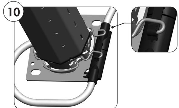
Der Federring (**5**) sollte bei Bedarf um 90 °gedreht aufgesteckt und wieder eingasetzt werden.
