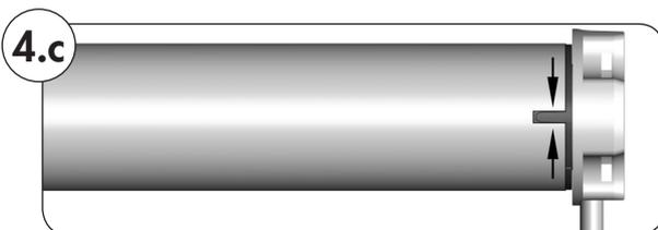
3. Den Rohrmotor (9) in das Präzisionsrohr schieben.
