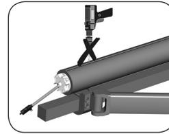
Nie im Bereich des Antriebs bohren oder schrauben. Das führt zur Zerstörung des Rohrmotors.
