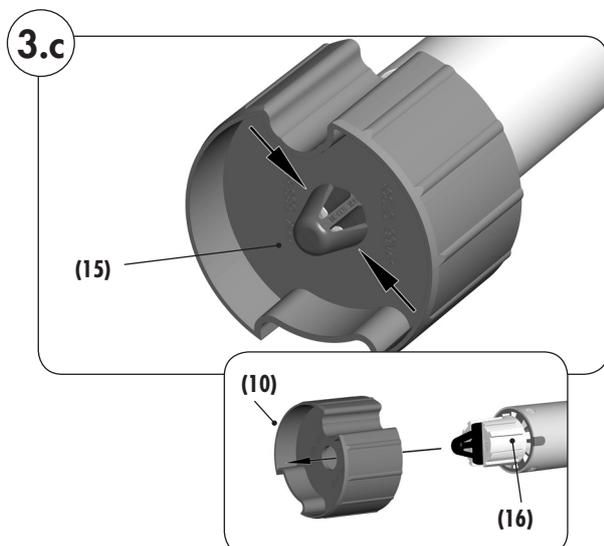
1. Drücken Sie die Seitenteile des Rastbügels (15) zusammen und ziehen die den Mitnehmer (10) vom Abtriebsadapter (16) ab.
