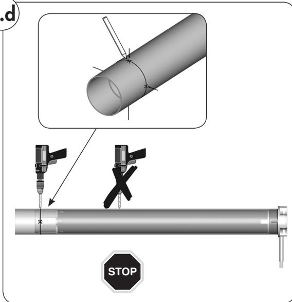
4. Markieren Sie vier Befestigungslöcher und bohren Sie diese anschließend durch das Präzisionsrohr in den Mitnehmer (10).
