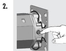
Den Verbinden-/Trennen-Modus des DuoFern-Rohrmotors durch kurzes Drücken der Setztaste (7) aktivieren.
