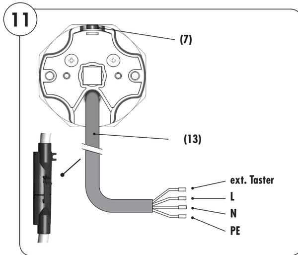
1. Verbinden Sie das Motorkabel (13) per Stecker mit dem beiliegenden Anschlusskabel und führen Sie den Anschluss gemäß der folgenden Adernbelegung durch.
