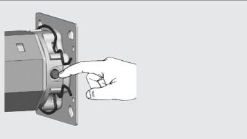
Die Setztaste (7) am Rohrmotor drücken und festhalten, bis der gewünschte Endpunkt erreicht ist.
