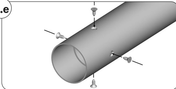
5. Das Präzisionsrohr am Mitnehmer (10) festschrauben oder vernieten.
