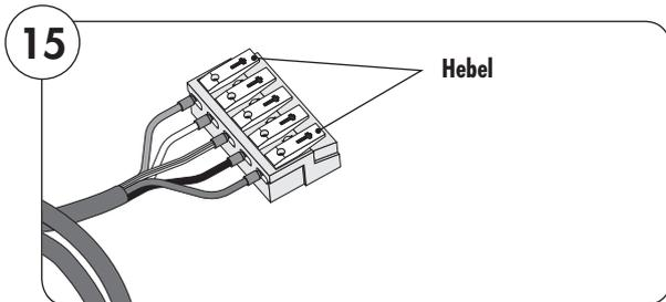
Bei einer Erstinstallation kann der Monteur das Motorkabel (13) an ein im Fachhandel erhältliches Schnurschaltersetzgerät (20) anschließen, um damit die Endpunkte Ihres Rohrmotors einzustellen.
