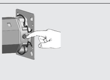
Durch kurzes Tippen der Setztaste (7) können Sie den Endpunkt in kleinen Schritten korrigieren.
